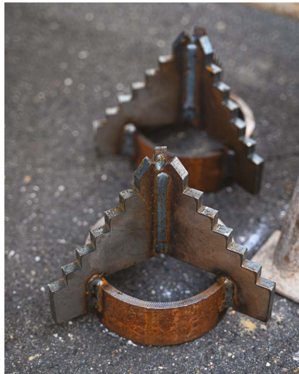
Pose de micro pieux destinés à l'ETCB (Enceinte de Traitement et de Conditionnement des déchets B) Têtes de forage. ©CEA-UADF
