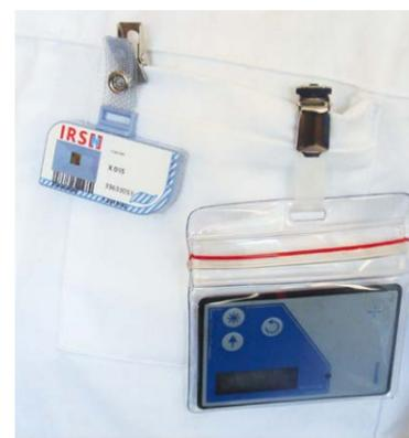
Dosimètre passif (à gauche), dosimètre opérationnel (à droite).
