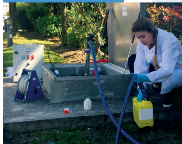
Prélèvement d'eau dans la nappe souterraine.
