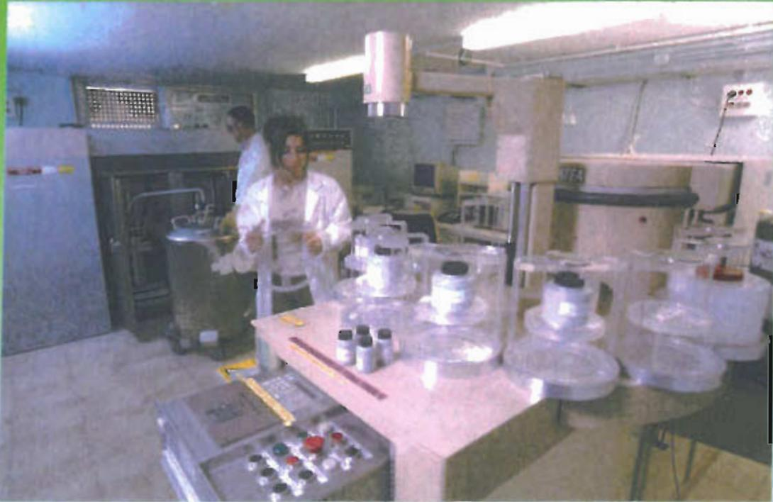
Passeur d'échantillons pour mesures par spectrométrie gamma
