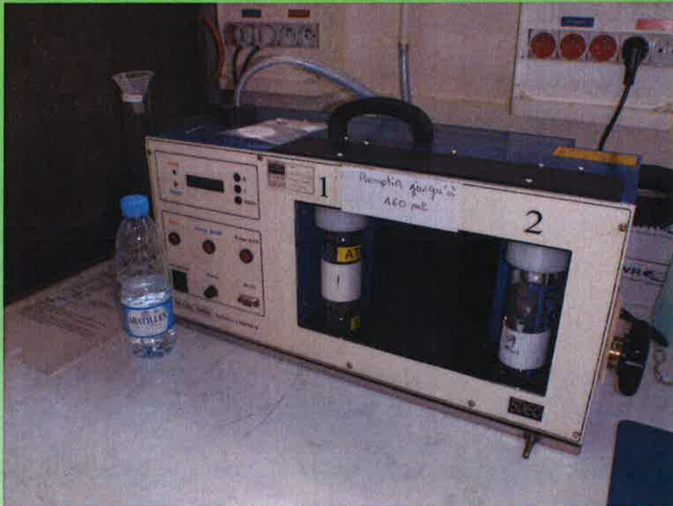
Barboteur à tritium de la station atmosphérique ATMOS
