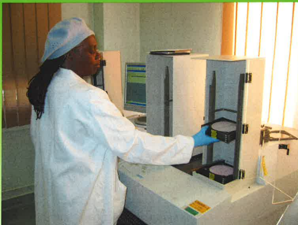
Comptage des filtres « rejets gazeux » sur les LB5500 de la Salle De Comptage
