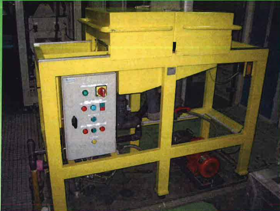
Cobenade : appareil de mesures bêta et gamma de l'Egout Urbain
