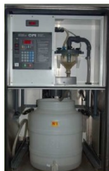
Préleveur automatique des eaux de l'égout urbain et des émissaires
