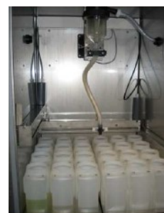
Préleveur automatique des eaux de l'égout urbain et des émissaires
