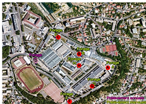
Figure 30 – Implantation des piézomètres sur le site de Fontenay-aux-Roses
