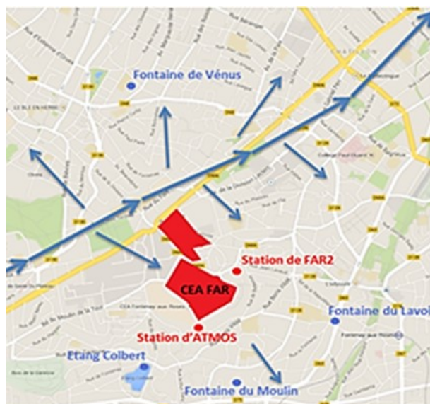
Figure 29 – Sens d'écoulement des eaux de la nappe des sables de Fontainebleau
